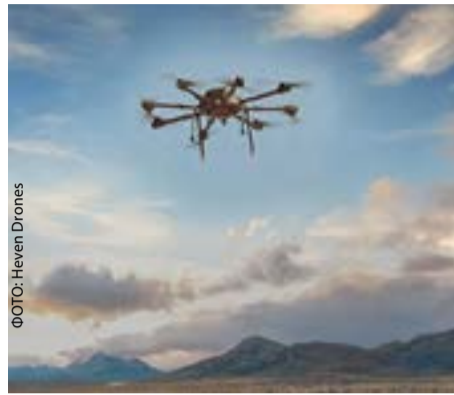
Тяжелый беспилотник H100 компании Heven Drones имеет грузоподъемность до 30 кг и время полета от 22 до 55 минут
